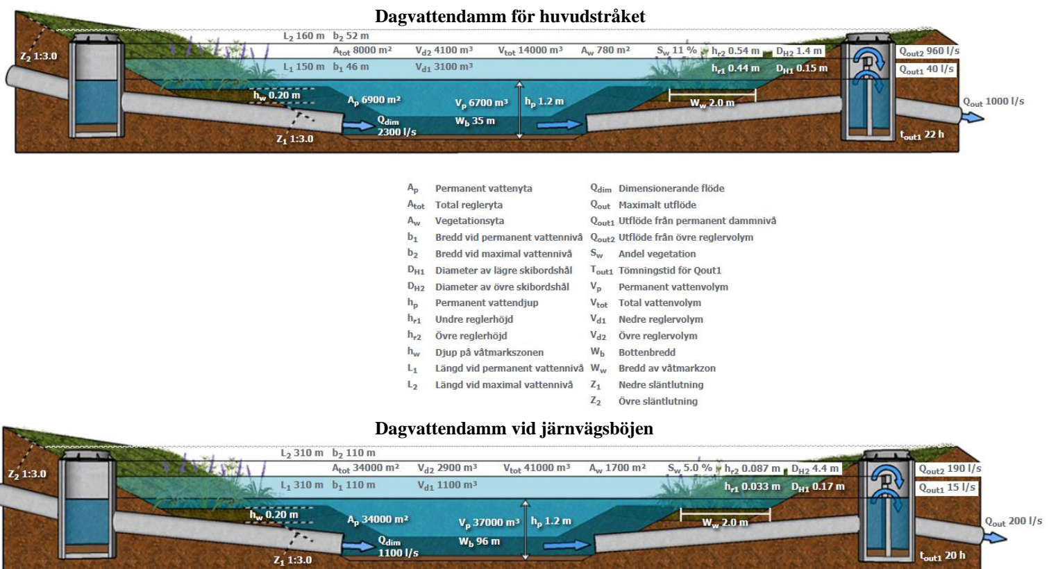
Figur 7. Illustration över hur dammarna kan utformas. Övan: Damm för huvudstråket. Under: Damm vid järnvägsböjen.
