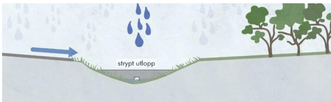
Figur 33: Illustration av torrdamm. Bild från dagvattenutredningen (Sweco Sverige, 2025).
