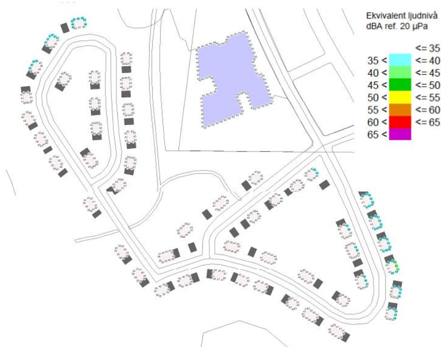
Figur 19 Högsta beräknade ekvivalenta ljudnivåer på fasad. Riktvärdet för bostäder avser 60 dBA och överskrids inte på någon fasad.
