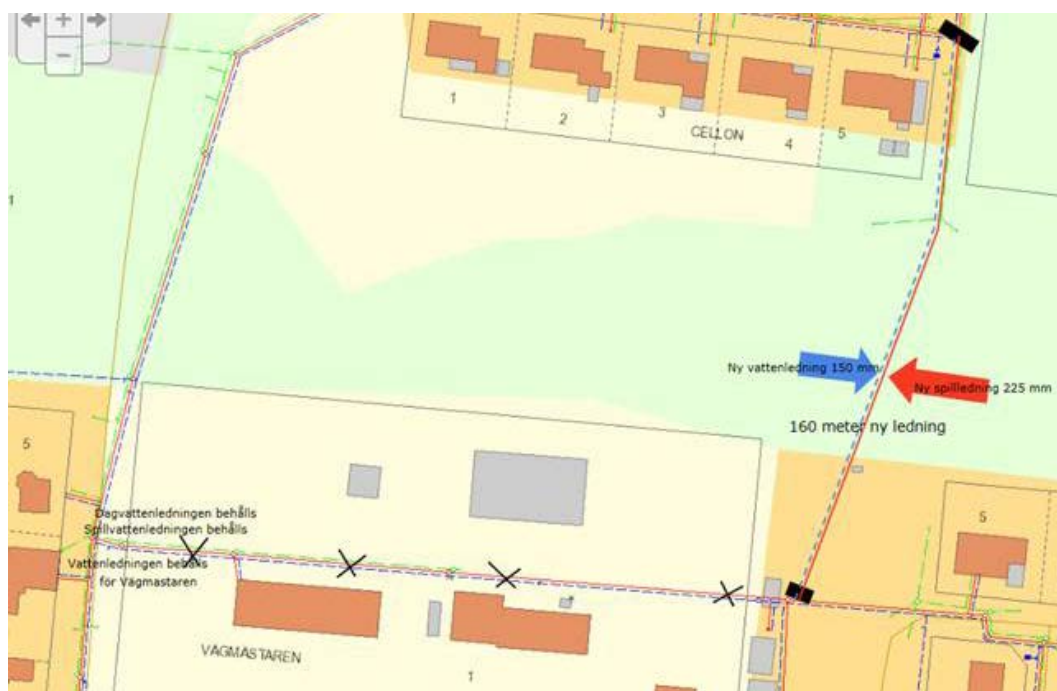
Figur 15. Möjlig placering av ny vatten- och spillvattenledning, samt ledningar som utgår vid ett genomförande av detaljplanen.
