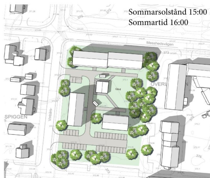
Figur 20. Bilderna ovan visar skuggningspåverkan (under sommaren) inom planområdet och detaljplanen maximala påverkan på närområdet.
