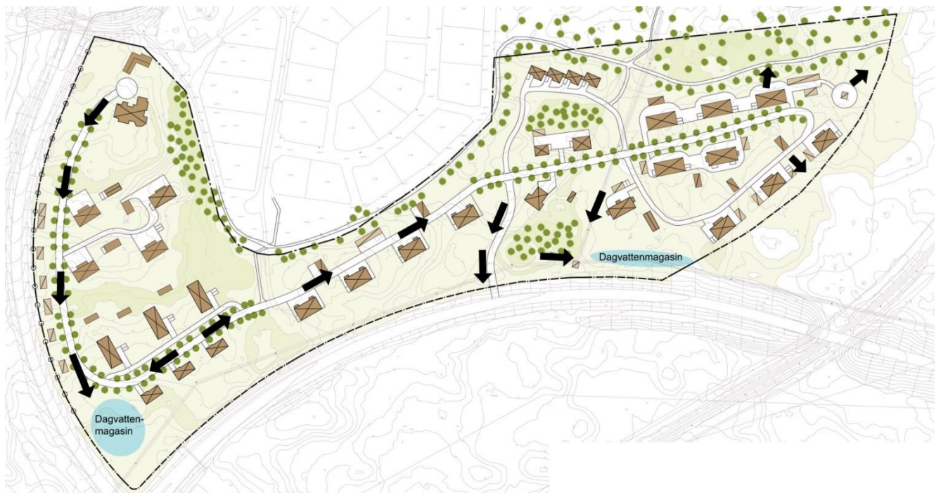
Figur 13. Översiktlig bild för hantering av dagvatten inom planområdet. Placering av dagvattenmagasin redovisas med blå områden och avrinningsriktningar med svarta pilar.
