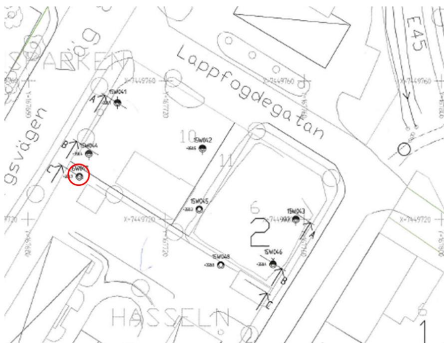
Figur 2. Påträffad diesellukt i torv vid geoteknisk undersökning (WSP 2015).
